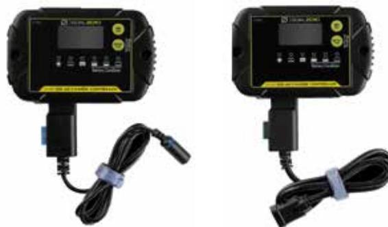
**CONTRÔLEUR DE CHARGE 10A****96100****CONTRÔLEUR DE CHARGE 20A****96110****Version 10A/Port 8mm :****Ports entrée :** Port femelle 8 mm 15-22V, jusqu'à 10A**Ports sortie :** M5**Version 20A/Port Haute Puissance :****Ports entrée :** Port Haute Puissance 15-22V, jusqu'à 20A**Ports sortie :** M5**Poids :** 272 g**Dimensions :** 155 x 99 x 26 mm**Compatibilité :** LifePo4, LTO, Gel, AGM, plomb-acide conventionnel (WET) et calcium
